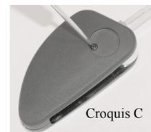
Puis à l'aide de l'extracteur de goupille ou avec un chasse-goupille traditionnel retirer la lame de son pivot. Faire la même chose sur avec la lame originale et goupiller la lame originale sur le nouveau pivot de la coque de remplacement
