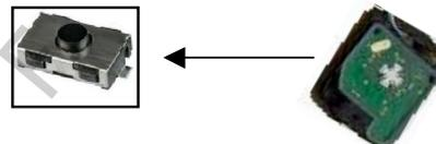
Emplacement du transpondeur « A » qui se trouve derrière la platine bouton « B »
